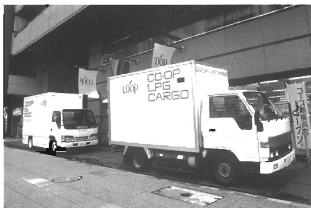
トヨタと共同開発したLPGトラック（右）と、第3次試作車
