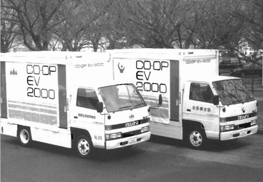
第2試作車に改良を加え、東京都の2生協が実際に現場で使った電気トラック。ボディは三方アコーディオン式開閉扉を採用している。
