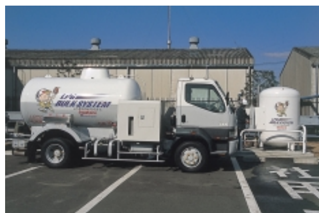
バルクローリとバルク貯槽（たて型）
