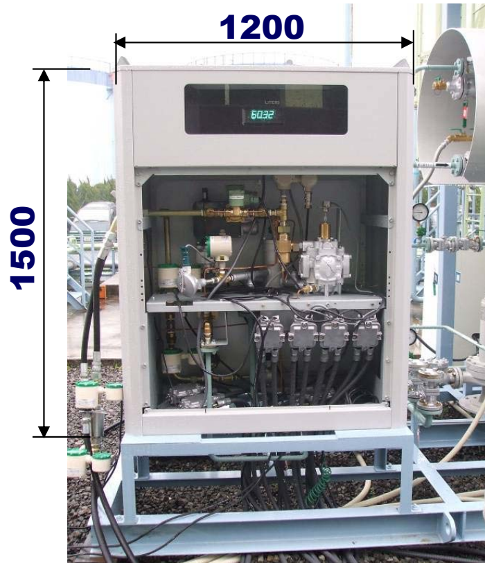
急速充填装置 + 急速充填装置制御盤 (20年度機能試作品)
